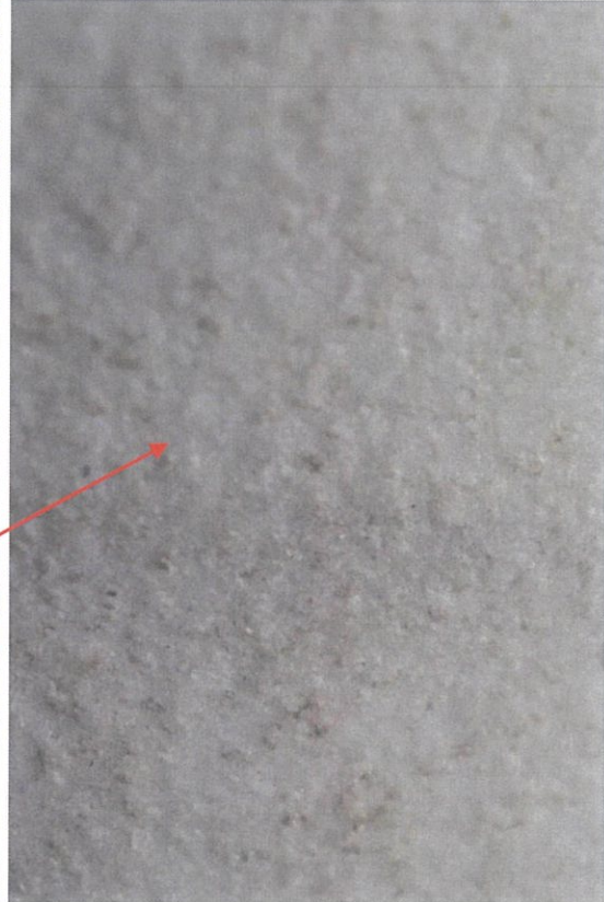
Εικόνα 8, 9: Ζαχαροποίηση στη μαρμάρινη στήλη που φέρει την προτομή του Νικηφόρου Γεωργιάδου.
