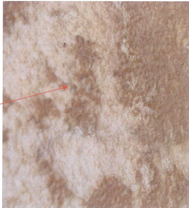
Εικόνα 10, 11: Ζαχαροποίηση σε μαρμάρινη προτομή στο ταφικό μνημείο Γεωργίου Γιαννίκογλου.
