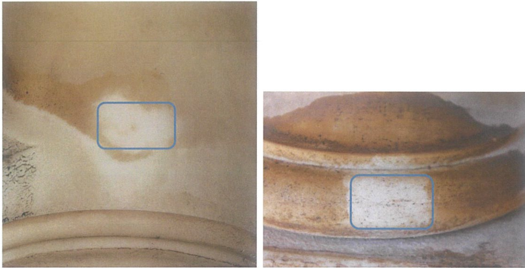
Εικόνα 19, 20: Δείγματα καθαρισμού με πάστα Moga στην πίσω όψη της προτομής του ταφικού μνημείου Νικηφόρου Γεωργιάδου και σε προτομή του ταφικού μνημείου Γεωργίου Γιαννίκογλου αντίστοιχα.
