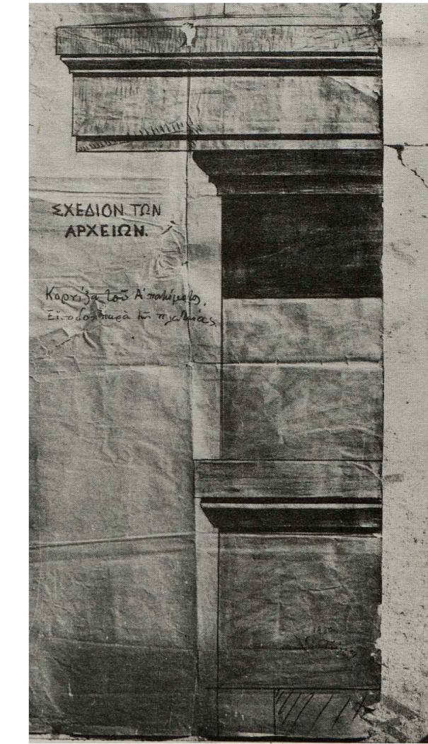
ΔΙΑΧΩΡΙΣΤΙΚΟ ΟΡΙΖΟΝΤΙΟ ΓΕΙΣΟ, ΣΦΟΡΟΣ ΚΑΙ ΕΠΙΣΤΥΛΙΟ ΜΕΤΑΞΥ Α' ΚΑΙ Β' ΟΡΟΦΟΥ (ΑΡ. ΓΕΝ. ΚΑΤ. 67)
